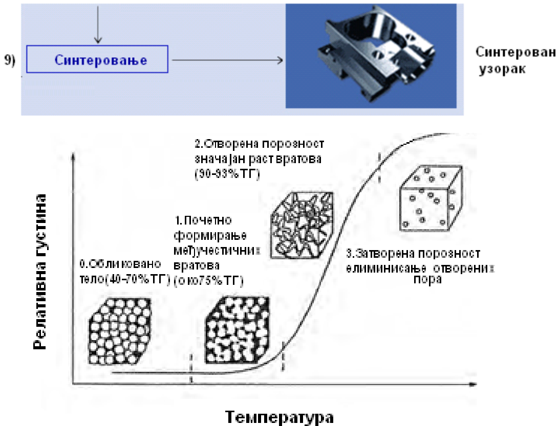
Слика 3.7 Промене релативне густине у зависности од температуре током процеса синтеровања
