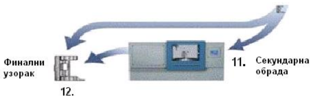
Слика 3.8 Процесни корак 11*додатне (секундарне) обраде произведених делова након синтеровања (12*финални део) у оквиру PIM/MIM технологије.
