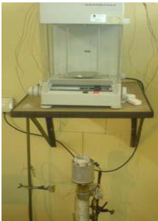
Слика 3.12. а) Фарадејева вага за испитивање магнетних и термомагнетних својстава материјала, б) принципска шема мерења магнетне силе, тј. масе на електронској ваги.
