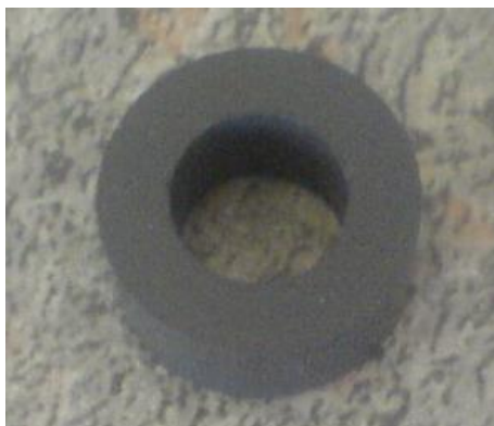
Слика 3.10 Узорак FeCoV легуре у облику торуса добијен PIM/MIM технологијом ињекционог бризгања након поступка високотемпературског синтеровања.
