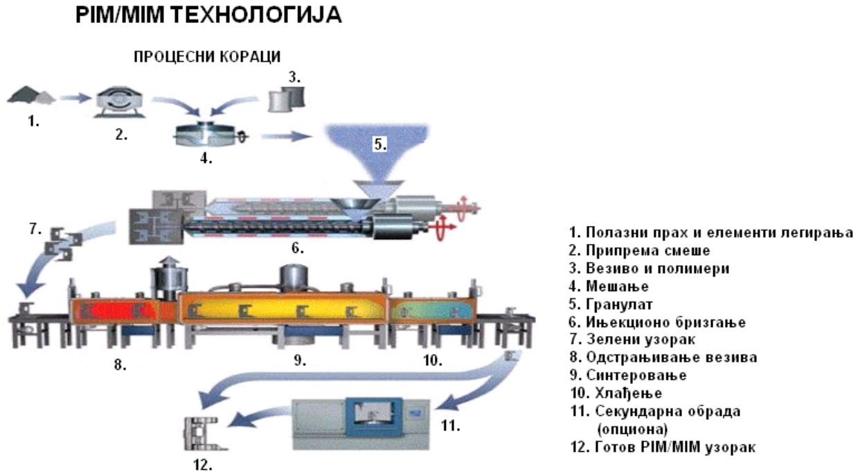
Слика 3.1 Процесни кораци бризгања композита праха са растопљеним везивом РІМ/МІМ технологија.
