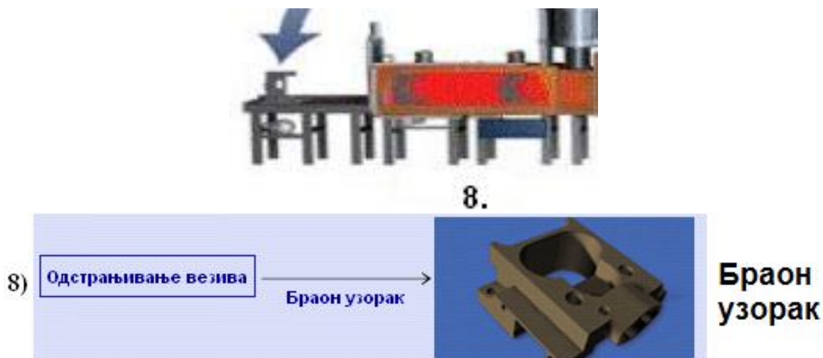
Слика 3.4 Процесни корак уклањања везива 8“дебиндинг” у оквиру PIM/MIM технологије, добијање браон узорка (“brown part”).
